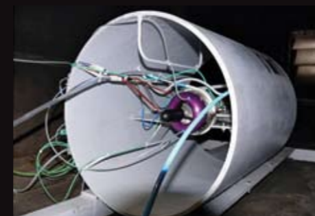
TESTSTAND: Für die EASA-Zulassung muss sich der Berstschutz der Turbine, ein Metallmantel, beweisen.
