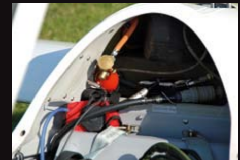
IM PROTOTYP ist der Verschluss der kleinen Propangasflasche gleich neben der Kopfstütze erreichbar.
